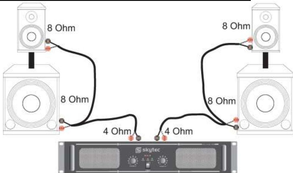
Bi Amp connection / Branchement bi-amplifié / Doppelverstärkeranschluss:
