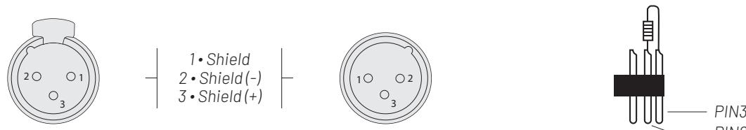
En uso profesional, la norma DMX512 requiere la presencia de un "tapón DMX" en el último dispositivo DMX de la cadena para finalizar correctamente el bucle de señal. Este tapón consta de una resistencia de 120 ohmios colocada entre el pin 2 y el pin 3 del conector XLR.
