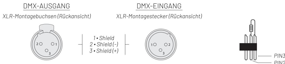
Bei Verwendung des Standard-DMX512-Steuerungssignals muss die Ausgangsschnittstelle des letzten Geräts mit einem DMX-Stecker verbunden sein. Dieser Stecker setzt einen 120-Ohm-Widerstand zwischen den 2 Pins und 3 Pins des "Kanon"-Steckers ein. Wie im folgenden Bild gezeigt. Wenn Sie diesen Stecker in die Ausgangsschnittstelle des letzten Geräts stecken, wird dies Interferenzen während des Signalübertragungsprozesses vermeiden.
