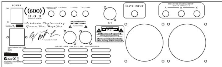
Dies ist eine Mono-Buchse für den Anschluss des Ashdown 4-Wege-Fußschalters (separat erhältlich) nur Schließen Sie dies immer an, bevor Sie die Stromversorgung an den Verstärker einschalten, da der Fußschalter seine Leistung vom Verstärker ableitet und einen seriellen Datenstrom an den Verstärker sendet, um die verschiedenen Funktionen zu bedienen.
