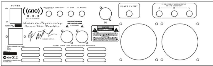
**ENTRÉE ESCLAVE** - Il ya une entrée esclave à l'arrière de la tête cela a été conçu pour être alimenté par les sorties isolées transformateur si l'exécution de plusieurs têtes à partir d'une source d'entrée ...
