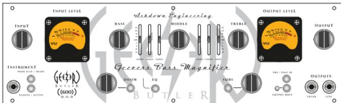
**ENTRADA** – Hay una sola entrada de instrumento proporcionada vinculada a un interruptor selector PASIVO/ACTIVO. La entrada pasiva (apagar) es de alta sensibilidad y también alta impedancia para adaptarse a la salida de graves PASIVOS. La entrada activa (switch in) es baja sensibilidad e impedancia inferior para adaptarse a la salida de graves ACTIVOS.
