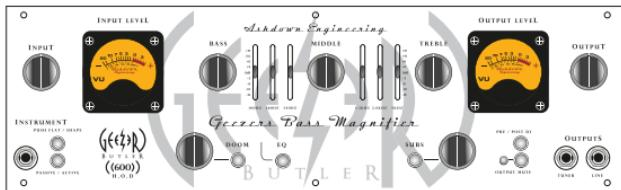
**EINGABE** – Es ist ein einzelner Instrumenteneingang vorhanden, der mit einem PASSIVE/ACTIVE-Auswahlschalter verknüpft ist. Der Passive Eingang (Ausschalten) ist hochempfindlich und auch hoch impedanz. Der Aktive Eingang (Einschalten) ist eine niedrige Empfindlichkeit und eine geringere Impedanz, um dem Ausgang von ACTIVE Bässen zu entsprechen.
