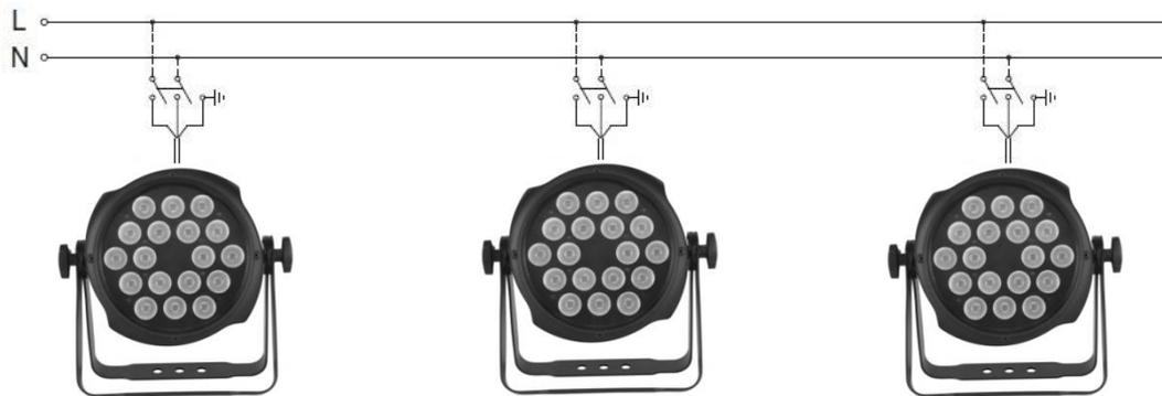
Il dispositivo deve essere collegato ad un sistema di alimentazione dotato di un'efficiente messa a terra. Inoltre, si consiglia di proteggere le linee di alimentazione dei prodotti dai contatti indiretti e/o da cortocircuiti verso massa utilizzando interruttori differenziali opportunamente dimensionati.
