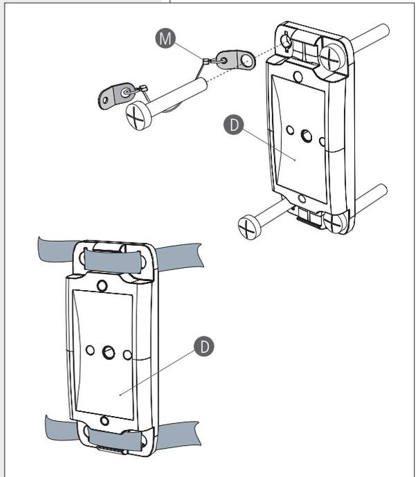
Il cavo del diffusore (lunghezza: 1 m) può passare attraverso la staffa a "U", un foro (apribile facendo pressione su uno dei due punti indicati qui a lato) e la sede posteriore dell'accessorio di montaggio, per raggiungere una nicchia / scatola eventualmente a tenuta stagna incassata nel muro, in modo da ottenere una connessione elettrica ben protetta dall'acqua e ridurre la parte esterna visibile del cavo.
