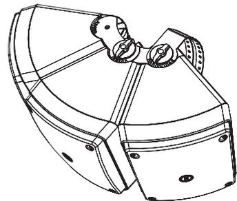
Lösen Sie die beiden Rändelknöpfe oder Bolzen des mittleren Lautsprechers ein wenig, um das Einsetzen des U-Bügels zu erleichtern. Stellen Sie anschließend sicher, dass alle Knöpfe / Bolzen fest sitzen.
