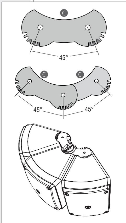
Formare il cluster unendo i tre diffusori e fissare quello centrale (e le quattro staffe di collegamento) stringendo due manopole **L** con bullone (sopra e sotto).
