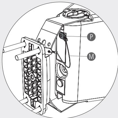
Verwenden Sie eine Schraube **P**, um das Sicherungsfangseil **M** zu befestigen (wie in der Abbildung dargestellt).
