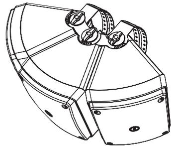
Das Cluster kann nun durch Festziehen der beiden Bolzen am Montagezubehör befestigt werden.
