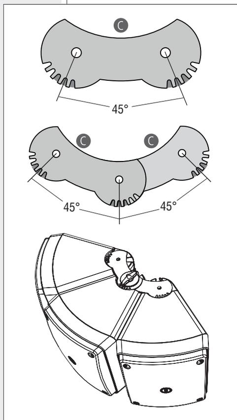
Beide U-Bügel müssen parallel zur Achse des mittleren Lautsprechers befestigt werden: Achten Sie darauf, die drei inneren Zwischenräume der Zahnung der Verbindungsplatte zu verwenden (in der Abbildung grau unterlegt).
