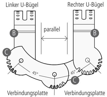
Fügen Sie dann den zweiten U-Bügel unter der Verbindungsplatte hinzu (im Beispiel den linken) und ziehen Sie die zugehörigen Rändelknöpfe oder Bolzen fest.
