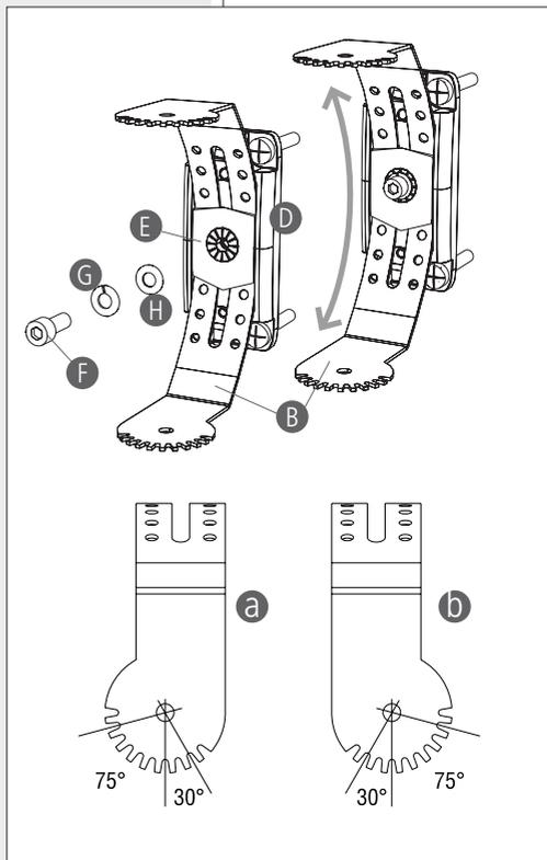
Der U-Bügel ermöglicht (im Falle einer vertikalen Montage) eine horizontale Ausrichtung des Lautsprechers von  $30^\circ$  nach rechts /  $75^\circ$  nach links (Abbildung **a**) oder von  $75^\circ$  nach rechts /  $30^\circ$  nach links (Abbildung **b**), abhängig von der Orientierung der Halterung. Jeder Schritt entspricht etwa  $15^\circ$ .
