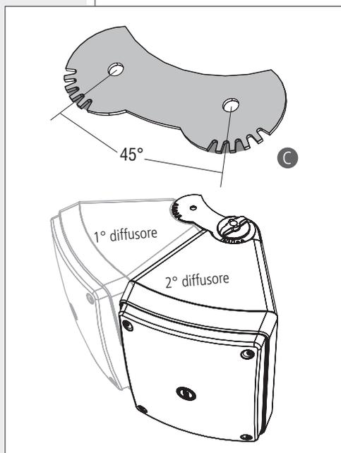
Montare il cluster ottenuto alla staffa a "U" stringendo altre due manopole per fissare il primo diffusore, attaccando il cavo di sicurezza in acciaio (già fissato all'accessorio di montaggio a parete) e le due staffe di collegamento (con il secondo diffusore). Prestare attenzione all'orientamento del cluster.
