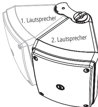
Befestigen Sie das Lautsprecher-Cluster am U-Bügel durch Festziehen der beiden übrigen Rändelknöpfe **L** oder Bolzen **F** am direkt anliegenden Lautsprecher sowie der Verbindungsplatte (mit dem zweiten Lautsprecher). Beachten Sie hierbei auch die horizontale Ausrichtung des Clusters.
